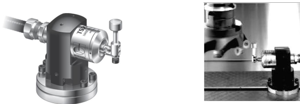
Рис. 5.3. Фотографии измерительного датчика TS-27: а – общий вид; б – измерение диаметра торцевой фрезы
