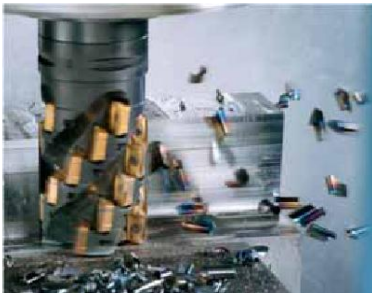
Рис. 3.4. Фотография концевой цилиндрической фрезы в работе на примере Sandvik Coromant.
